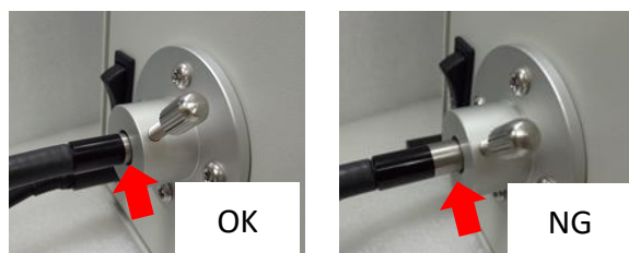
光導管與光導管座連接 (圖 5)
